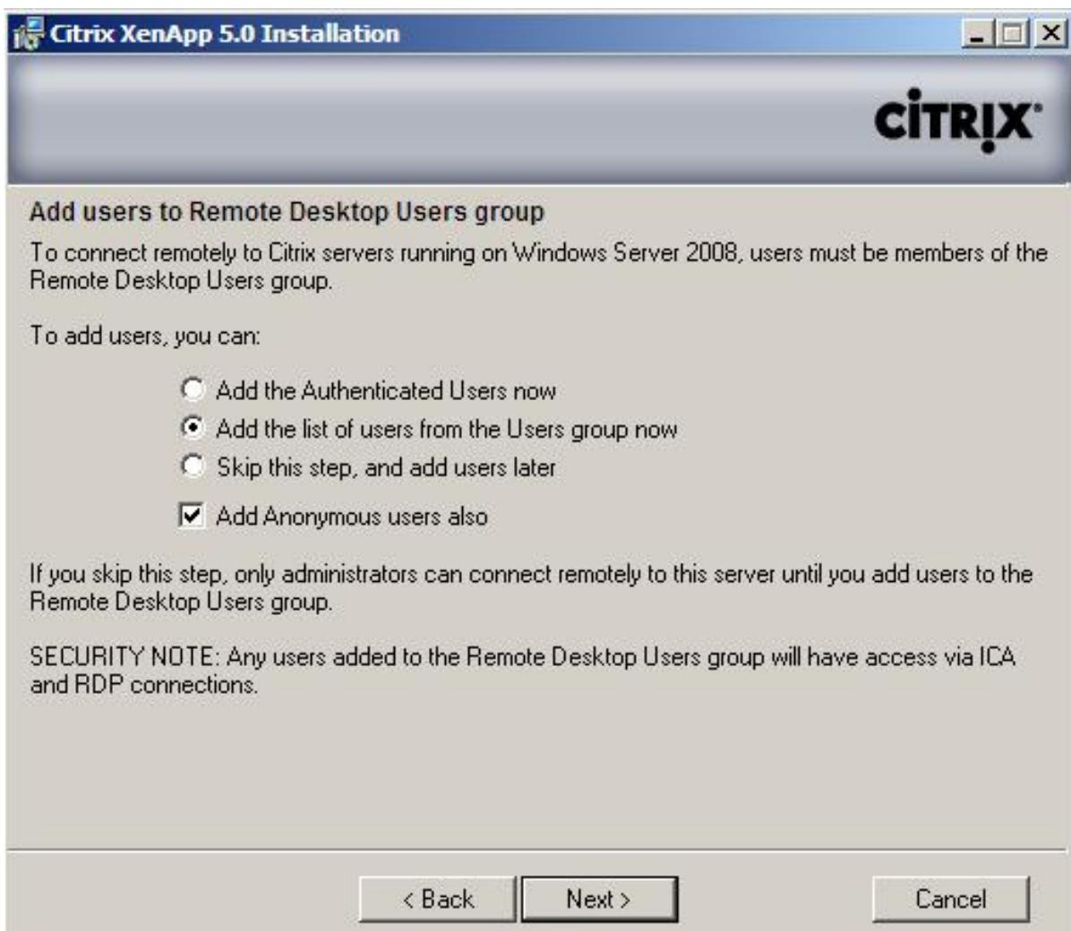
Específicamente en la instalación de XenApp 5.0 para Windows Server 2008, se pide que se añada el grupo de usuarios "Remote Desktop Users" a los usuarios que se van a conectar remotamente.
